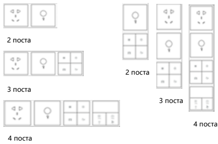
Рис 5. Горизонтальная установка Рис 6. Вертикальная установка
