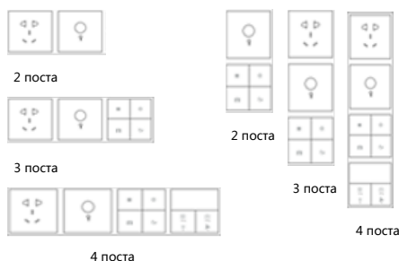
Рис 10. Горизонтальная установка Рис 11. Вертикальная установка
