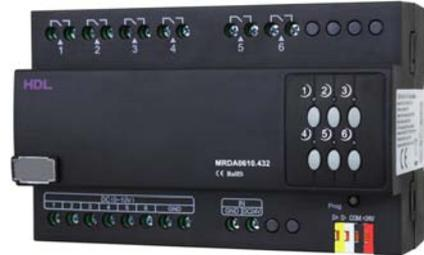
**HDL-MRDA0610.432** 6 канальный 10A модуль с выходами DC0 - 10V - это многофункциональный модуль управления. 6 каналов выходов реле, подходят для функции вкл/октл. 6 каналов аналоговых выходов 0-10V (поддерживается вход и выход), которые используются для диммирования флуоресцентных ламп, 0-10V LED ламп и т.д. Модуль используется для управления освещением, включения/отключения в офисах и зданиях.
