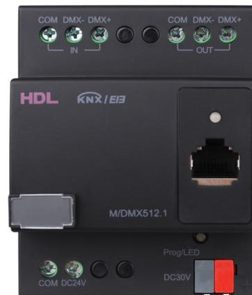
KNX/DMX регистратор это не только шлюз KNX/DMX, который поддерживает двунаправленное управление, но так же он может делать записи, проигрывать и удалять DMX программы из ETS или панели KNX. Максимально до 4 часов записи. Используется для управления устройствами со встроенным DMX протоколом, такими как смена цвета LED, лазер, подвижная головка.
