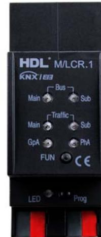
HDL-KNX линейный соединитель - модуль который используется как соединитель или повторитель (для усиления сигнала). При использовании в качестве соединителя может быть подключен к другой линии или магистральной линии. Требуется отдельное питание для каждого нового сегмента и изолирования каждой линии. Линейный соединитель может фильтровать команды и пропускать их или блокировать на смежные линии.
