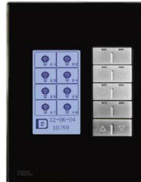
**HDL-MPL8.46** восьмикнопочный многофункциональный LCD переключатель - это новое поколение переключателей с настенной установкой. 8 кнопок, левая и правая сторона кнопки программируется отдельно. 2 кнопки используются для листания страниц. Каждой кнопке можно присвоить иконку на LCD дисплее.
